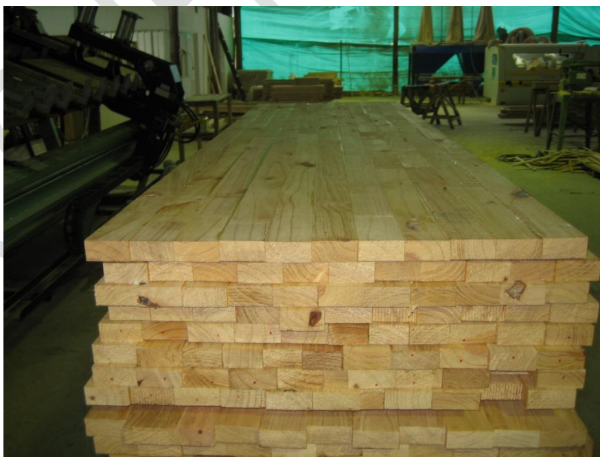
Figura 8. Tablero enlistonado fabricado con madera de pino caribe
